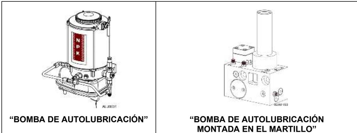
Los sistemas de autolubricación NPK están diseñados para proporcionar automáticamente un suministro continuo de grasa al martillo y al buje, lo que aumenta la vida útil de ambos al reducir el desgaste. Las bombas de autolubricación pueden bombear grasa EP2 en climas fríos. La salida de la bomba se puede ajustar según los reemplazos del modelo de martillo y también para compensar el desgaste del buje de la herramienta.
