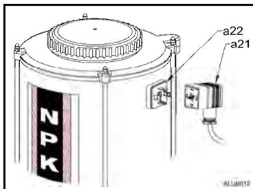
2. Remplir le réservoir (a2) à l'aide du graisseur, jusqu'à ce que la graisse touche à la sonde (a22).
