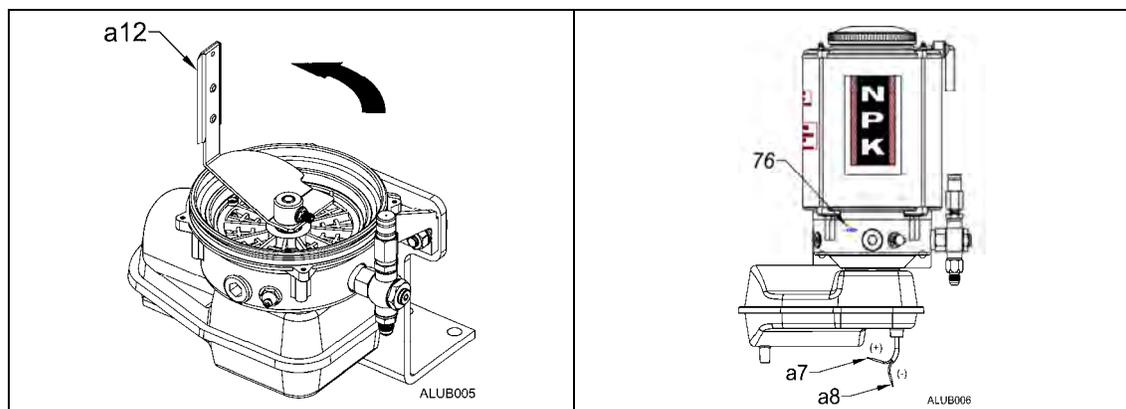
Si le bras pivote dans le sens horaire, la position des connexions électriques est inversée et doit être corrigée. Le câble bleu (a7) est un câble positif (+) et le câble brun (a8) est un câble négatif (-). *Le système de lubrification automatique ne pompera pas de graisse si le bras pivote dans le mauvais sens.*
