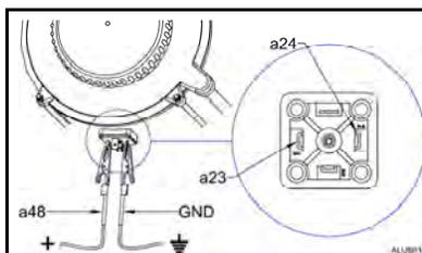
4. Utiliser un voltmètre (t45); si la sonde est bonne, la patte no 3 (a25) ne présentera **PAS** de tension. Si le voltmètre détecte de la tension à la patte no 3, la sonde doit être remplacée. (S'il n'y a pas de graisse sur la sonde, patte no 3 sera **CHAUDE**.)
