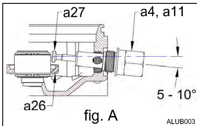
3. Lorsque la cartouche est enlevée, s'assurer que le piston ne reste pas à l'intérieur du boîtier de la pompe. Le cas échéant, le retirer à l'aide d'un aimant.
