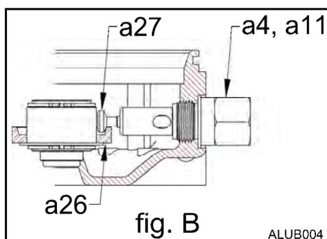
2. Installer une cartouche ajustable (a4) ou non ajustable (a11) alors que le piston (a27) est dégagé d'environ 1 po.
