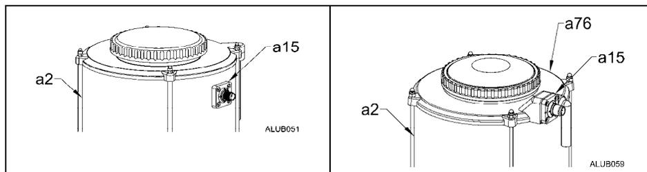
Les deux emplacements peuvent être testés sans retirer le système de lubrification automatique de l'appareil. Cet essai nécessite une source d'alimentation de 12 ou 24 VCC et une mise à terre.
