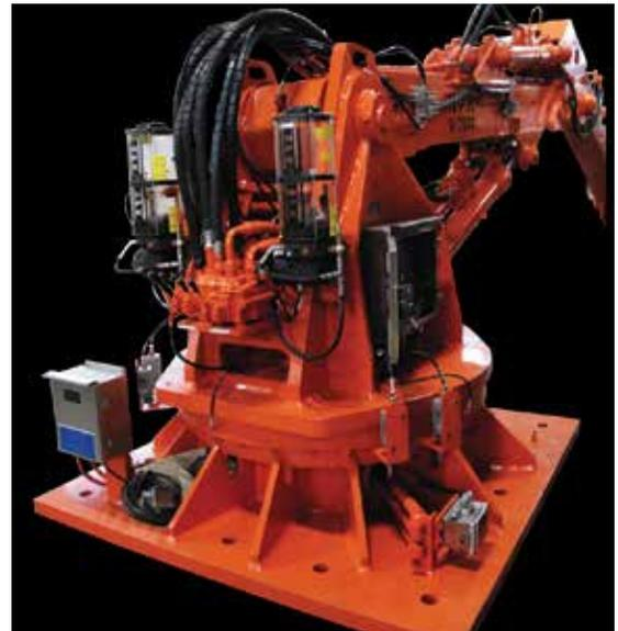
**Rotation de base ensemble** comprend une couronne d'orientation qui permet précises à 270° (plus) de positionnement. Montré avec option systèmes de lubrification automatique.
