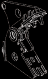
Juego de mandíbulas "G" (Pulverización) Placa dentada reemplazable
